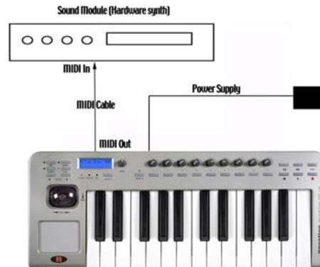
Asegúrate de que todo el equipo está apagado. Conecta el MIDI Out del ReMOTE LE al MIDI In del módulo de sonido. Debes trabajar con pilas o con la fuente de alimentación (Novation PSU6) - ver sección previa para más información. Conecta cualquier otro dispositivo como un pedal de sustain al ReMOTE LE. Enciende todos los aparatos.
